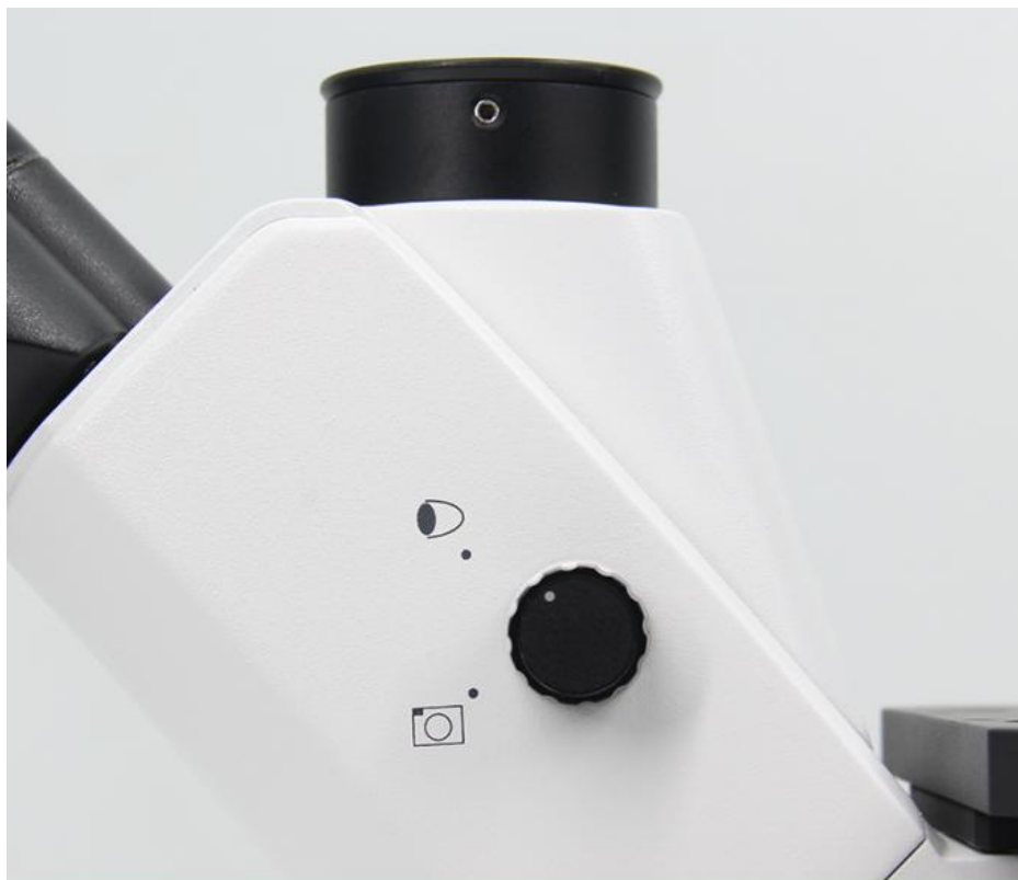
Seidentopf Trinocular Head Light Split Switch E100:P0 / E20:P80
